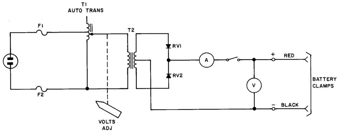
Fig. 3—J86264A Rectifier—Schematic
